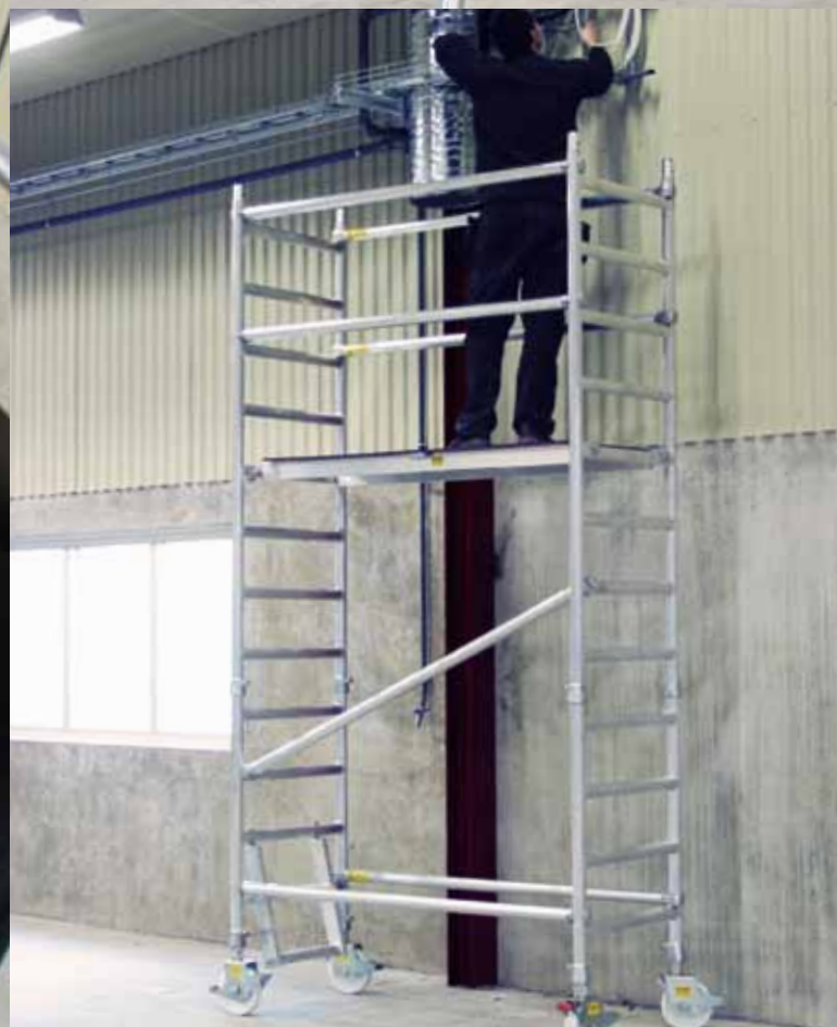
Rullställning 0,7 x 1,7 m. Övre plattformshöjd 2,32 m (totalhöjd 3,47 m).
